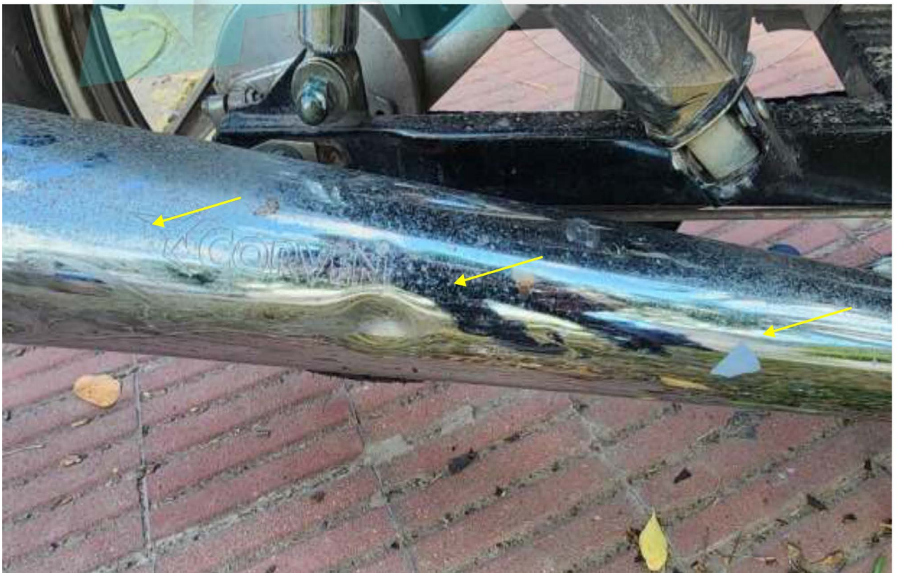
Fotografía N° 9: Vista del lateral derecho de la motocicleta Marca Corven. Se puede observar el hundimiento y fricciones con adherencia de pintura de color gris sobre el caño de escape. (Fotografía Div Criminalística. SIGI Orden 25)
