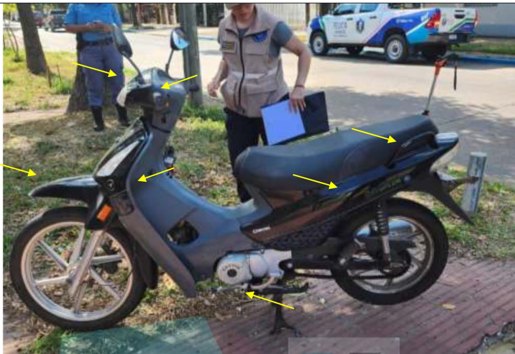
Fotografía N° 6: Vista del lateral izquierdo de la motocicleta Marca Corven. Se pueden observar los daños por caída: raspaduras sobre guardabarros delantero, efracciones en pechera pollera y cubre pierna, y rotura de espejo retrovisor, efracción en agarradera lado izquierdo.- (Fotografía Div Criminalística. SIGI Orden 25).
