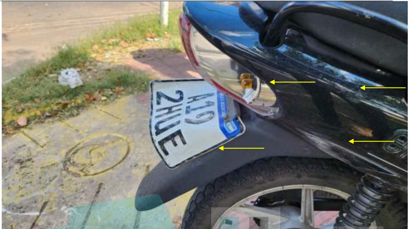
Fotografía N° 10: Vista del lateral derecho de la motocicleta Marca Corven. Se puede observar el plegamiento de la chapa patente, fricciones con adherencia de pintura de color gris en amortiguador posterior lado derecho y carenado bajo asiento lado derecho, las fricciones se presentan orientadas de adelante hacia atrás, rotura faro trasero derecho. (Fotografía Div Criminalística. SIGI Orden 25)
