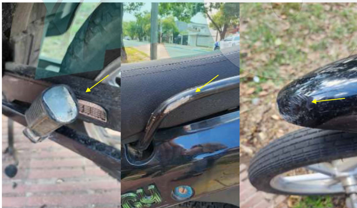
Fotografía N° 13: Vista del lateral izquierdo de la motocicleta Marca Corven. Se pueden observar los daños por caída: raspaduras sobre guardabarros delantero, efracción en agarradera lado izquierdo, efracciones sobre apoya pies lado izquierdo.-
