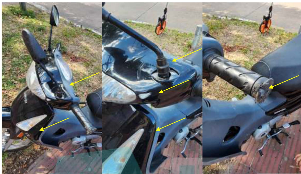
Fotografía N° 14: Vista del lateral izquierdo de la motocicleta Marca Corven. Se pueden observar los daños por caída: raspaduras o efracciones en pechera pollera y cubre pierna, y rotura de espejo retrovisor, efracción en manopla lado izquierdo.- (Fotografía Div Criminalística. SIGI Orden 25).
