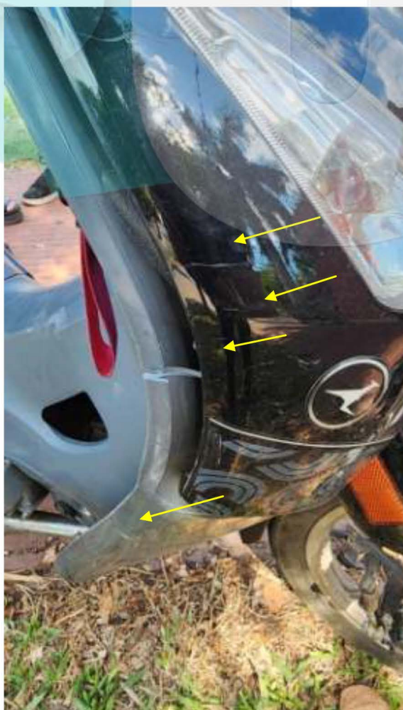
Fotografía N° 7: Vista del lateral derecho de la motocicleta Marca Corven. Se puede observar que las fricciones se presentan orientadas de adelante hacia atrás con adherencia de pintura, quiebre de cubre pierna lado derecho y efracciones sobre pechera y cubre pierna. (Fotografía Div Criminalística. SIGI Orden 25).
