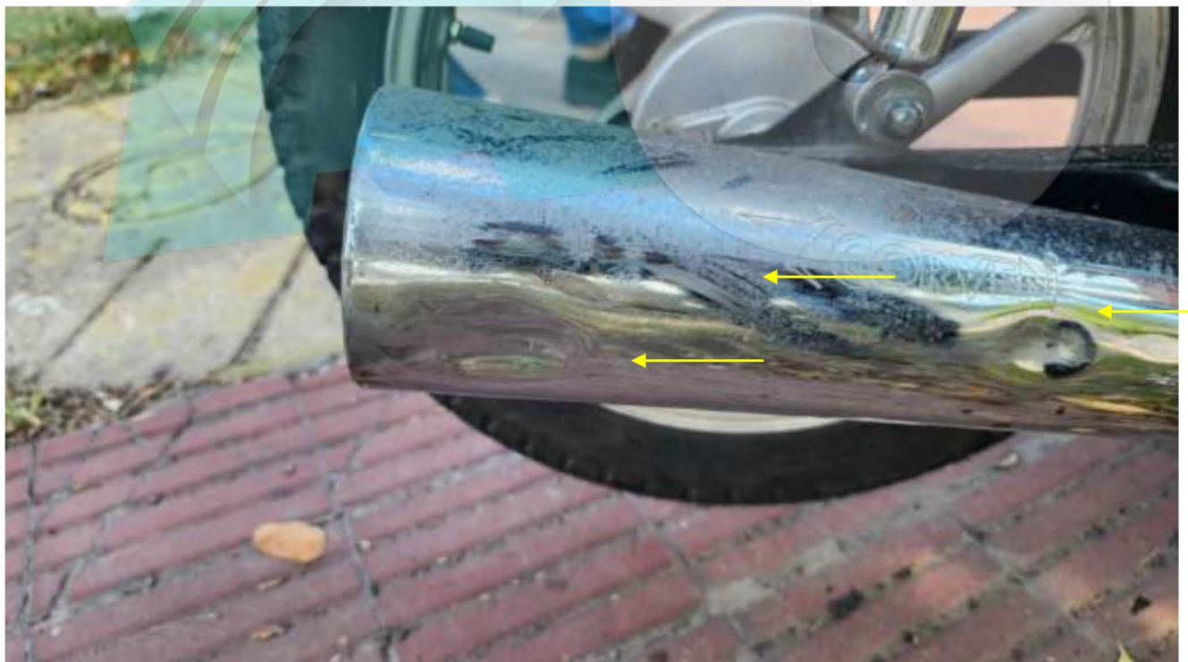
Fotografía N° 11: Vista del lateral derecho de la motocicleta Marca Corven. Se puede observar el hundimiento y fricciones con adherencia de pintura de color gris sobre el caño de escape. (Fotografía Div Criminalística. SIGI Orden 25).
