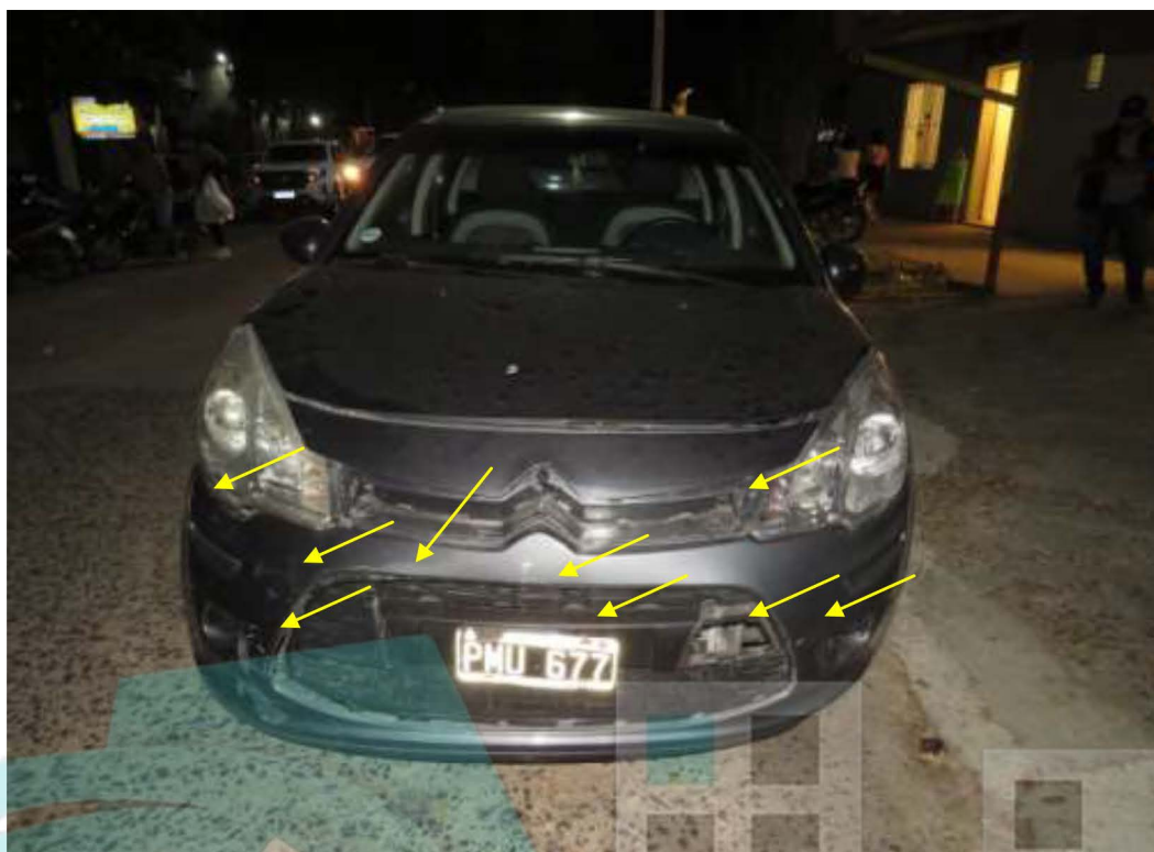
Fotografía N° 16: Vista del frente del automóvil marca Citroen, modelo C3, color gris, Dominio PMU 667, se pueden apreciar en la imagen registrada en Intervención N° 100/2025, los daños existentes en el frente del vehículo como consecuencia de un siniestro de tránsito.
