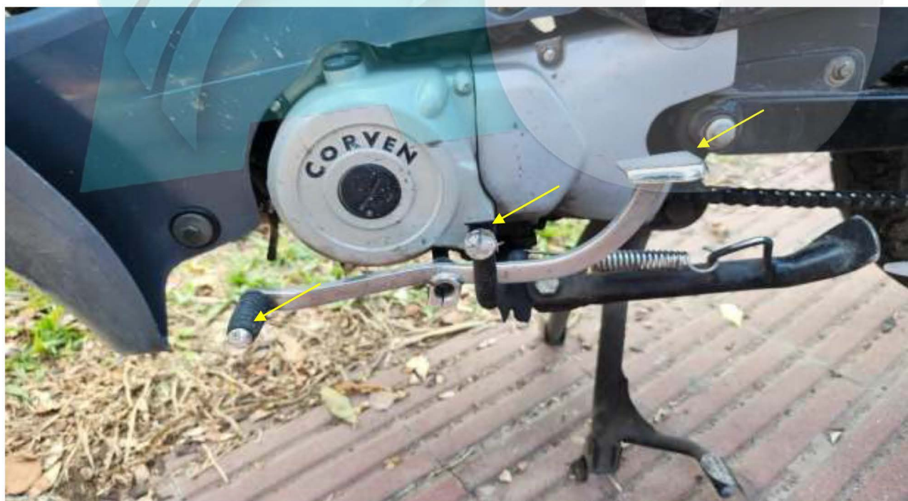
Fotografía N° 15: Vista del lateral izquierdo de la motocicleta Marca Corven. Se pueden observar los daños por caída: raspaduras o efracciones sobre piezas sobresalientes del lado izquierdo- (Fotografía Div Criminalística. SIGI Orden 25).
