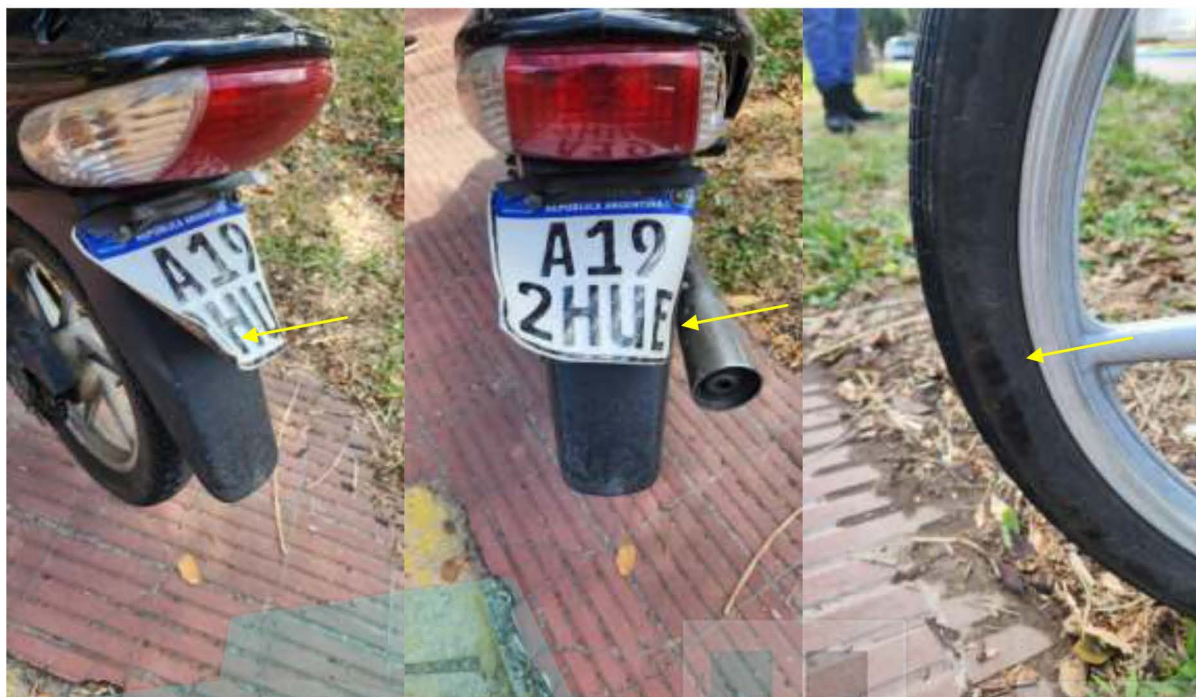
Fotografía N° 12: Vista del lateral izquierdo de la motocicleta Marca Corven, corresponde a daños por caída. Se puede observar el plegamiento de la chapa patente, efracciones sobre neumático lado izquierdo.- (Fotografía Div Criminalística. SIGI Orden 25).
